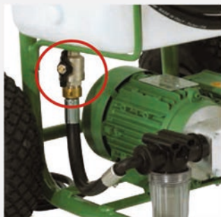
Absperrhahn aus Metall, stoßsicher positioniert
